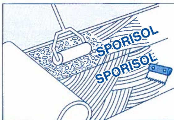
Figure 5 - Passage du rouleau à poils mi-longs après encollage
